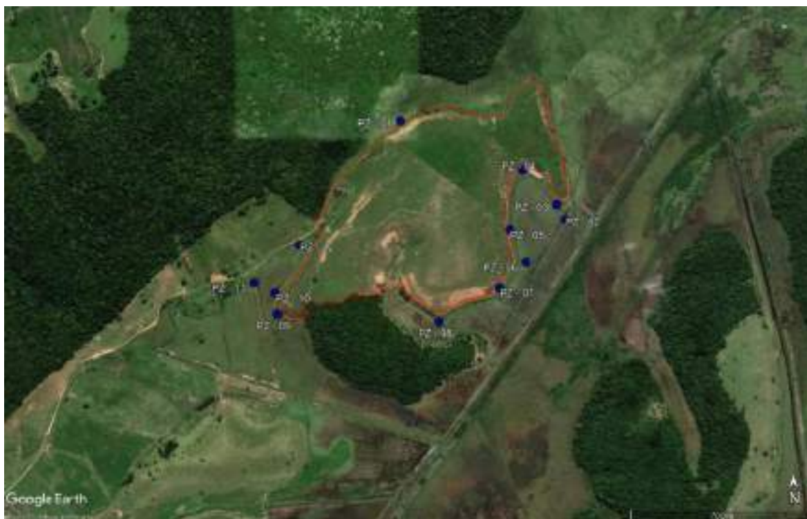
Figura 7.2.5-3). O terreno é composto por sedimentos dos depósitos flúvio-lagunares. As sondagens a trado executadas para a instalação dos piezômetros mostraram que os sedimentos na área são predominantemente argilosos, apresentando por vezes intercalações de argila com frações de areia média a grossa. Alguns perfis litológicos indicaram a presença de camadas de argila orgânica com espessuras variando de 0,8 a 2,7 m ( Figura 7.2.5-4 ).
